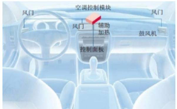
典型方案为：空调是电动空调、暖风为PTC暖风，制冷制热迅速；空调ECU是全自动空调系统，主要由传感器、空调ECU和执行器三部分组成，采用模糊控制。主要的细节过程为空调ECU的传感器检测室外温度、湿度、压缩机的工作条件、温度设定信号、功能选择信号通过比较、计算并发出指令，自动开启和关闭变频压缩机、冷凝器风扇、电动冷却泵和PTC加热器，最终调整送风的空气温度和空气流量，实现智能控制。
