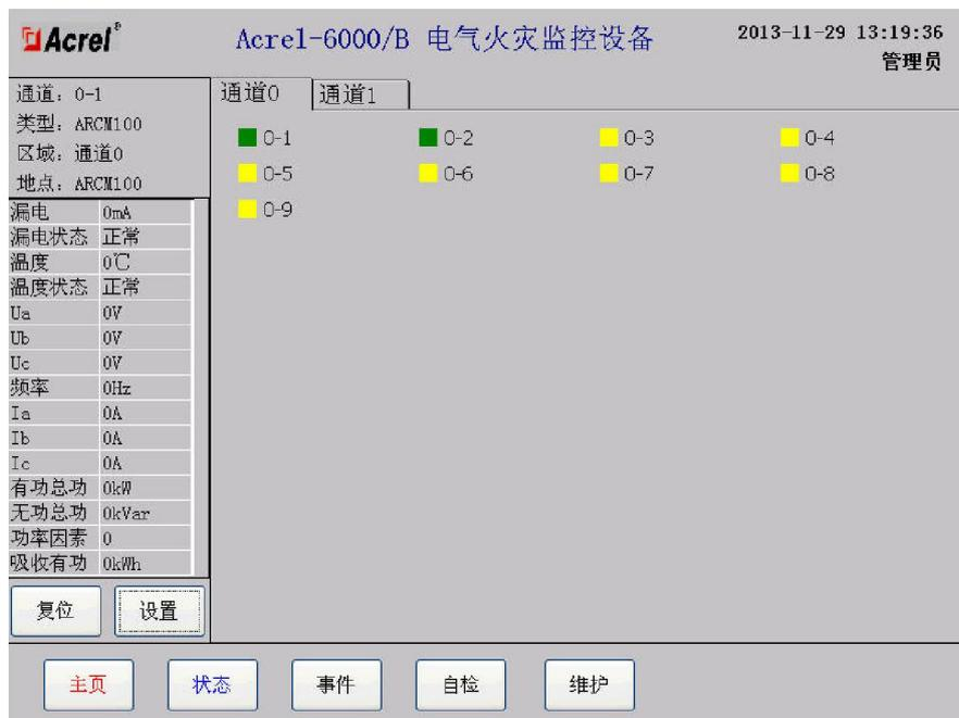
图 11 探测器状态显示界面
