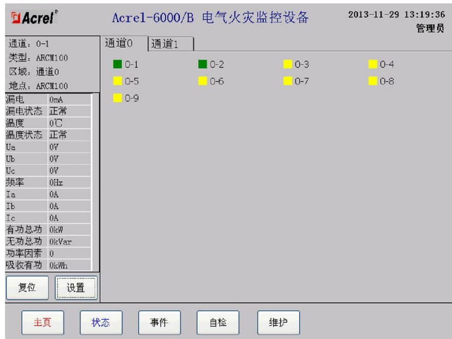
图 9 探测器通讯故障信息提示界面
