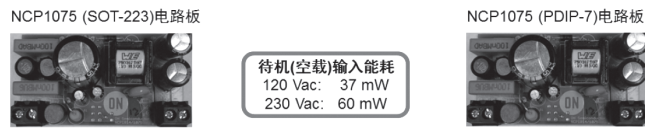
图 2 用于智能电表、电表及白家电等应用的 NCP1072/5 5W ~ 10 W 参考设计
