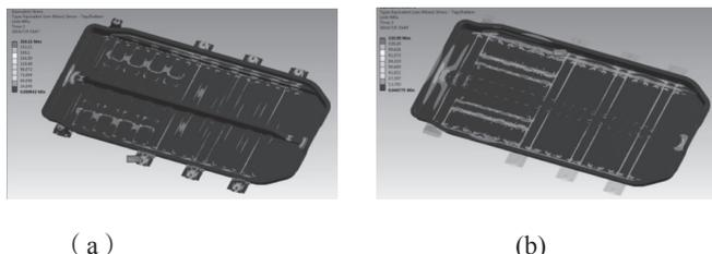
图3 优化前箱体等效应力云图：(a) 整体；(b) 底板
